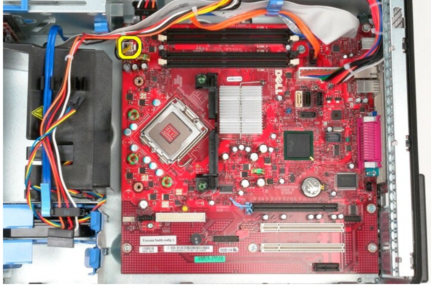
7. افصل كبل الطاقة الرئيسي للوحة النظام.
