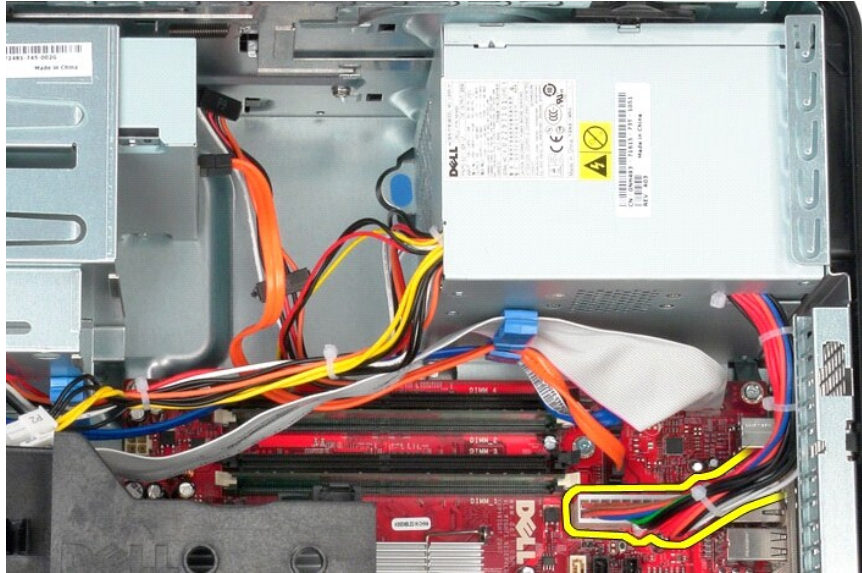
7. قم بإزالة كبل بيانات لوحة IO (الإدخال/الإخراج) من موجهات الكبلات في قاعدة وحدة الإمداد بالطاقة.
